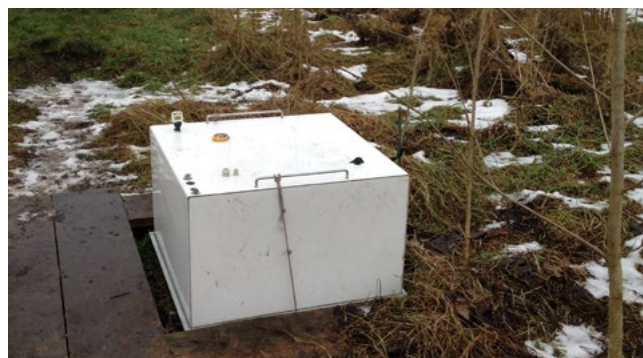
Gaswechselhaube zur Erfassung der \text{CH}_4 - und \text{N}_2\text{O} -Flüsse
