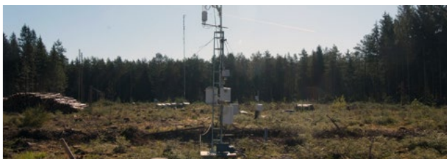
Die beiden Eddy-Kovarianz Messtürme (Höhe 4 m und 30 m) in Mooseurach
