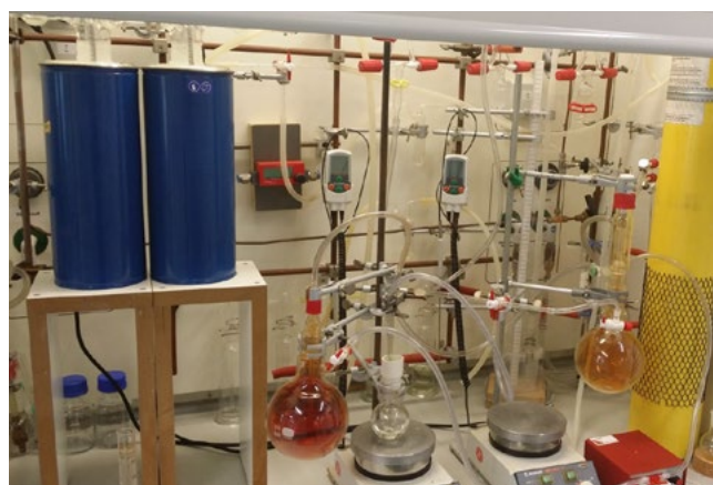
Abb.3: Kreislaufapparatur zur Umsetzung von Olefinen mit N 2 O 3 . Im Vordergrund die Gaskolben, die definierte Mengen von reinem NO und Sauerstoff (farblos) getrennt enthielten und zu hellem N 2 O 3 (braun) im Kreislauf reagieren.
