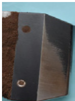
Abb. 10: Beschichtetes Prismenschar nach 50 m
