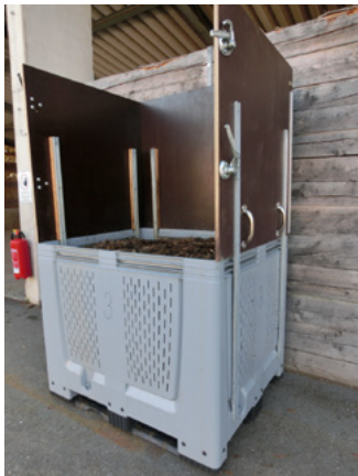
Abb. 1: Kompostbox für kleinmaßstäbliche Kompostierversuche mit Hopfenrebehäcksel
