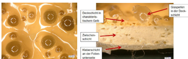
Abb. 1 (li): Aufsicht auf eine unbenutzte retroreflektierende Verbundfolie
