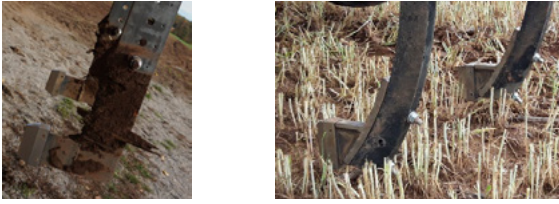
Abb. 7 und 8: Ursprüngliche Konstruktion mit Prismenscharen (li) und verstärkten Konstruktion mit Prismenscharen (re)
