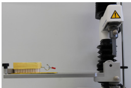
Abb. 7: Einsatz der Bürste zur Reinigung der Folie
