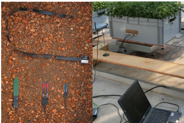
Abb. 1: Einbau volumetrischer Bodenfeuchtesensoren in ein extensives Dachsubstrat (links) und wägbaren Teststand zur Kalibrierung volumetrischer Bodenfeuchtesensoren mit Lupine als Testpflanze (rechts)
