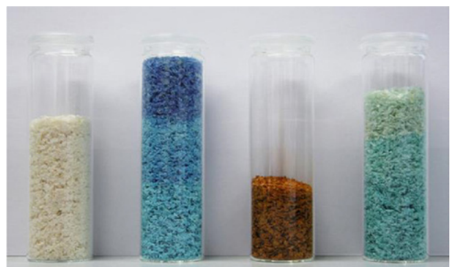
Abb. 3: Abtrennung von Schwermetallen mit Chitosan als Flockungsmittel: links reine Chitosanflocken, daneben Chitosanflocken mit gebundenem Kupfer (blau), Eisen (rot) und Nickel (grün); (Bild: IPF Dresden / M. Mende; Quelle: Vogel, 2018)
