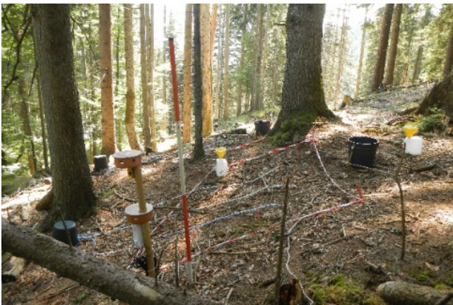
Abb. 3: Eingerichtete Fläche zur Messung von Nährstoff-, Wasser- und Temperaturhaushalt im Estergebirge auf 1200 m ü. NN. (Foto: M. Kohlpaintner)
