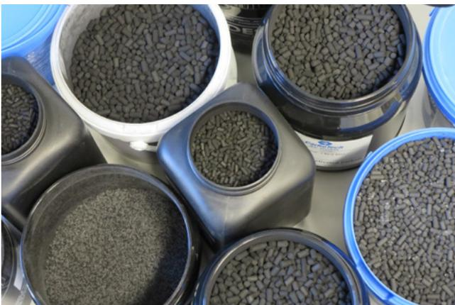
Abb. 2: Aktivkohleproben zur Entschwefelung des Biogases
