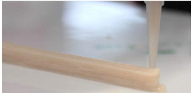
Abb. 2: 3D – Druck von parallel angeordneten Einzelsträngen aus pflanzlichen Rohstoffen
