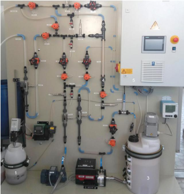
**Abb. 2: Pilotanlage für halbtechnische Versuche (1 – Suspensionsbehälter, 2 – Pumpenblock, 3 – Rührkessel, 4 – Querstromfiltrationsmodul, 5- Schaltschrank)**
