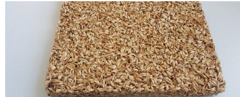
BODENDÄMMPLATTE AUS GETREIDESPELZEN
