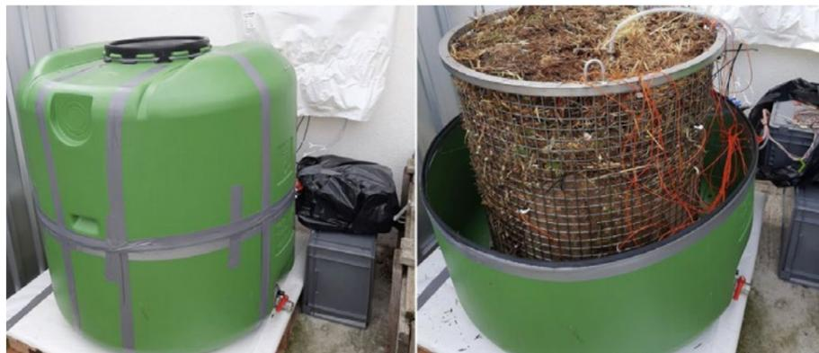
GECHLOSSENER UND OFFENER TECHNIKUMSREAKTOR ZUR SKALIERUNG FÜR DEN REALMASSTAB
