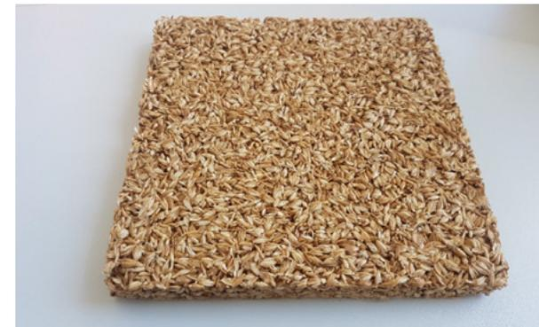
Test-Bodendämmplatte aus Basis von Getreideschalen. Foto: HSWT
